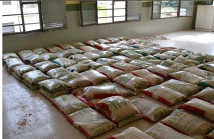
Foto 27: Otra prueba de carga realizada en otro punto del forjado.
