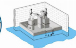
Figura 51: Esquema barrera protección de equipamientos (FEMA)
