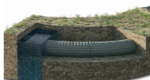
Figura 61: Protección de canalización subterránea (Huesker)
