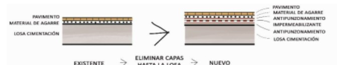
Figura 15: Impermeabilización de losa de cimentación
