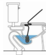
Figura 27: Globo en el WC (UK Flood Barriers Limited)
