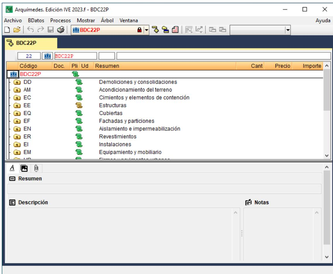
Para comprobar que los paramétricos van correctamente realizaremos una prueba. Buscaremos un paramétrico (siempre acabo en \$), pulsaremos sobre el icono y comprobaremos que podemos varias las opciones. En el ejemplo, tipo de excavación, tipo de terreno, medio de trabajo y profundidad de excavación.
